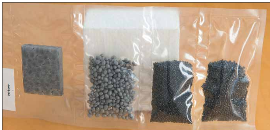
PSLoop – vom extrudierten Polystyrol-Granulat zur neuen EPS-Dämmstoffplatte aus 100 % recyceltem Polystyrol.
